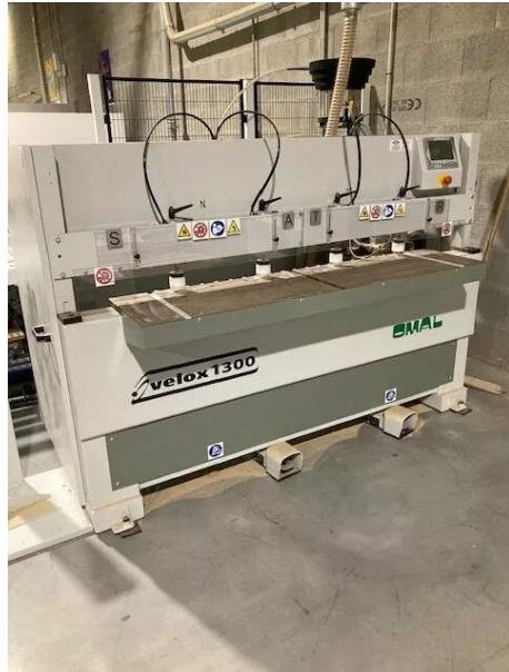
Nous proposons à la vente cette OMAL Velox 1300, machine CNC horizontale hautement performante pour perçage, encollage et insertion automatique de tourillons (goujons). Issue d'un atelier professionnel, elle est en excellent état, très peu utilisée et parfaitement fonctionnelle.
