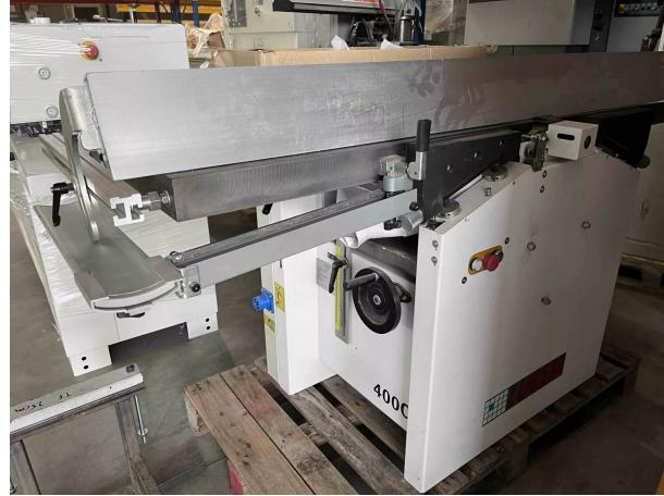
La machine combinée 2 Opérations Lurem Type 400 C est une dégauchisseuse-raboteuse robuste, idéale pour les ateliers de menuiserie. En version 220V monophasée (3 kW), elle offre des plans de travail larges (400 mm pour dégauchissage et rabotage) et une hauteur maximale de 220 mm en rabotage. Elle combine précision et polyvalence pour un usage professionnel efficace. Puissante et fiable, elle assure des finitions de qualité sur divers bois.
