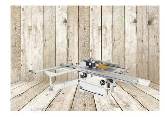
Largeur de travail (raboteuse) : 410 mm Tables de surfaçage longueur totale: 1800 mm
