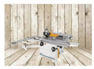
Largeur utile de travail (raboteuse) : 300 mm Longueur totale des plans : 1300 mm
