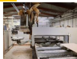
Centre d'usinage à commande Numérique RARE SCM MORBIDELLI AUTHOR M800 TV 5 AXES
