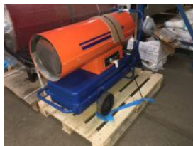
Chauffage –fioul – générateur mobile SMG type GF 50 A
