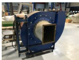
Moto Ventilateur IMAS type GR 900 travaillant en dépression
