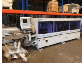
Plaqueuse de chant numérique HOMAG type KDF 850 highflex 1650
