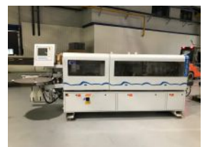
Plaqueuse de chant numérique Homag type KDF 530 plaqueuse entretenu par HOMAG chaque année
