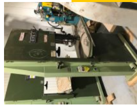
Scie à ruban SIPA type TPO 600
