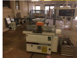
Toupie SCM - type T150 class - inclinable 3 axes à arbre interchangeable
