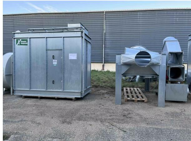
Groupe filtrant FMVZ-SD – Nettoyage par vibration
