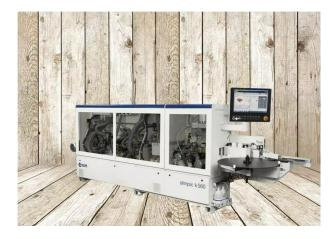
Epaisseur chant 0,4 - 6/8 (12 opt.) mm Epaisseur panneau 8 - 60 mm Vitesse d'avance 12 - 18 m/min Air comprimé 6 bar Options:
