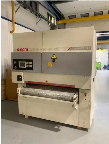
La ponceuse calibreuse : cette machine sert à la finition et calibrage des bois massif et des panneaux. Elle permet de calibrer et poncer une surface en un temps record avec une parfaite précision et finition, cela selon le grain des bandes utilisé. Machine de production qui permet de gagner beaucoup de temps dans le cadre du ponçage.
