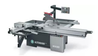
Longueur de chariot 3200 mm Interrupteur Marche/Arrêt au chariot 7,5 kW (10 CV) avec 3 vitesses de rotation, 3/4/5000 tr/min Inciseur réglable hauteur électrique Guide d'équerre 90° fixe 3200mm Guide parallèle CNC 1300 mm STEG support de pièces supplémentaire
