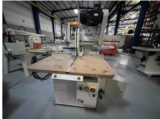
La STROMAB PS 600/P est une scie pendulaire robuste destinée à la coupe du bois, équipée d'une lame de 600 mm de diamètre et un alésage de 30 mm tournant à environ 2100 tr/min. Elle offre une capacité de sciage maximale de 460 mm de largeur et 210 mm de profondeur en coupe droite. Avec sa tête orientable pneumatique, elle permet des coupes en biseau à 45° jusqu'à 325 mm de largeur. Idéale pour les ateliers de menuiserie exigeant .
