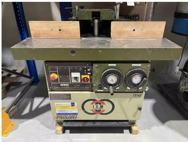
Année 1998 inclinaison + 45° - 5 ° manuel par volant/vernier montée et baisse manuel par volant/vernier table de 1300 mm x 800 mm moteur 7.5 ch double sens de rotation 5 vitesses de rotation: 3000/4.500/6000/7.500/10 000 TOURS /mn guide de toupie AIGNER avec barrettes escamotable entraîneur automatique 4 galets Toupie en excellent état
