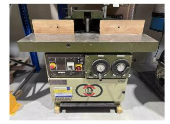
Année 1998 inclinaison + 45° - 5° manuel par volant/vernier montée et baisse manuel par volant/vernier table de 1300 mm x 800 mm moteur 7.5 ch double sens de rotation 5 vitesses de rotation: 3000/4.500/6000/7.500/10 000 TOURS /mn guide de toupie AIGNER avec barrettes escamotable entraîneur automatique 4 galets Toupie en excellent etat
