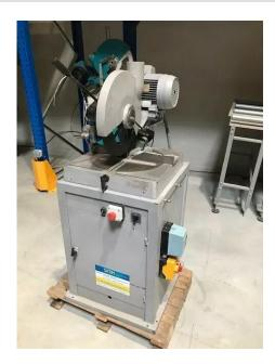
Capacité ( mm ): Lame de diamètre 300 mm Outils de coupe: 1 lame alu de diamètre 300 mm
