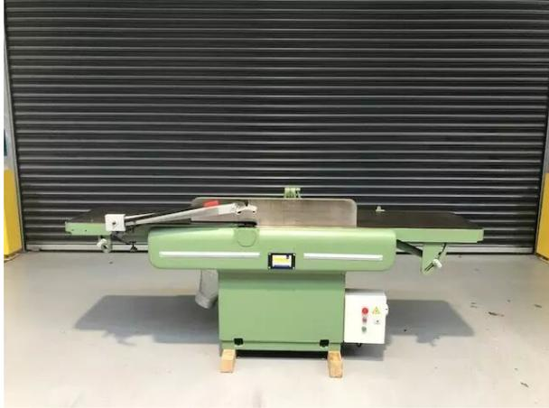
La dégauchisseuse est une machine-outil de travail du bois (charpente, menuiserie...) qui permet de dégauchir des pièces de bois brutes, c'est-à-dire les rendre droites et planes
