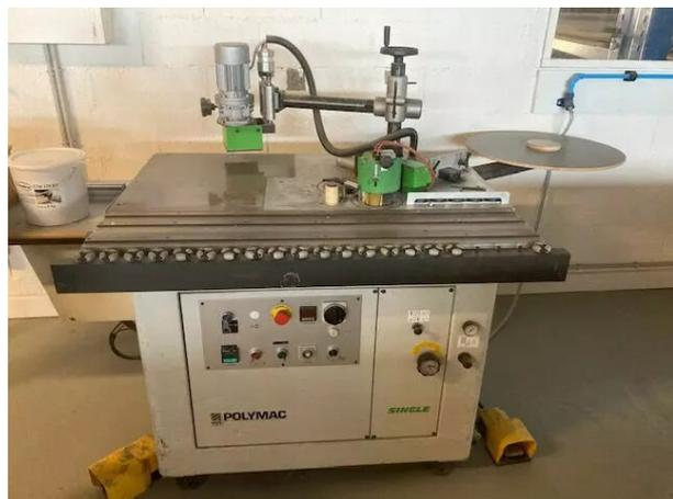
Description d'une plaqueuse de chant pour pièces courbes: Cette affleureuse est le complément des plaqueuses droite unilatéral ou double. Elle permet d'affleurer les chants sur des panneaux de formes concaves ou convexes avec un rayon de courbures assez petit, 20 mm.
