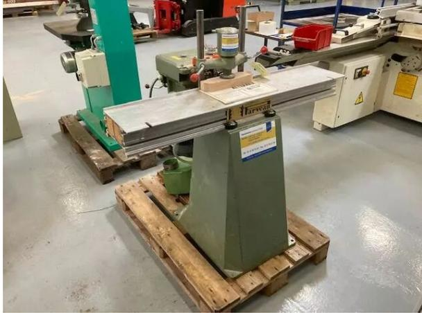
Description d'une ponceuse de chant: cette ponceuse permet de poncer les chants des panneaux et des bois massif en toute sécurité. En droit, courbes concave ou convexe. Elle est dotée d'une oscillation de bande qui lui permet de prolonger le temps de vie des bandes abrasives sans les brûler ou les user prématurément.
