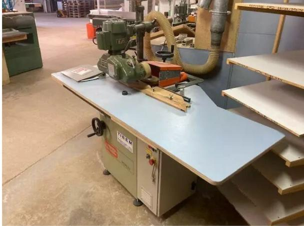
Description d'une ponceuse de moulures : Machine qui permet un grand gain de temps quand l'opérateur a beaucoup de moulures à poncer droites. Et cela permet d'avoir un profil après ponçage linéaire et régulier vu que l'entraînement est motorisé.
